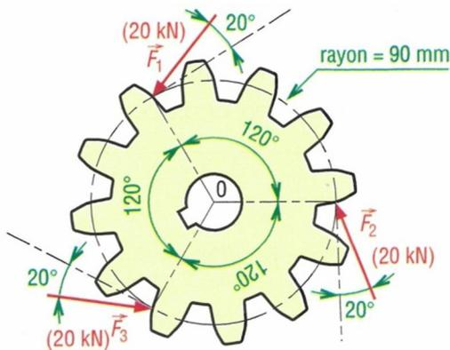
Les forces  $\vec{F}_1$ ,  $\vec{F}_2$  et  $\vec{F}_3$  schématisent les actions exercées par d'autres roues dentées.
