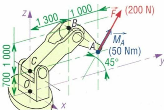
Un robot à cinq axes supporte en A la charge  $\vec{F}$  (200 N) et le couple  $\vec{M}_A$  (50 N.m) indiqués sur la figure.
