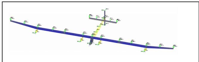
Du point de vue énergétique, 17248 cellules solaires sont nécessaires. Cela signifie une surface d'aile de 200 m<sup>2</sup> et impose une envergure d'ailes de 72,3 m
