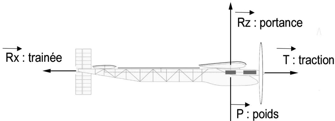
Les actions aérodynamiques génèrent la portance (force qui « porte » l'avion et qui vient compenser le poids de l'avion qui l'entraîne vers le bas) ainsi que la traînée (force induite notamment par le frottement qui s'oppose au mouvement et vient donc en opposition à la traction exercée par le moteur de l'avion).
