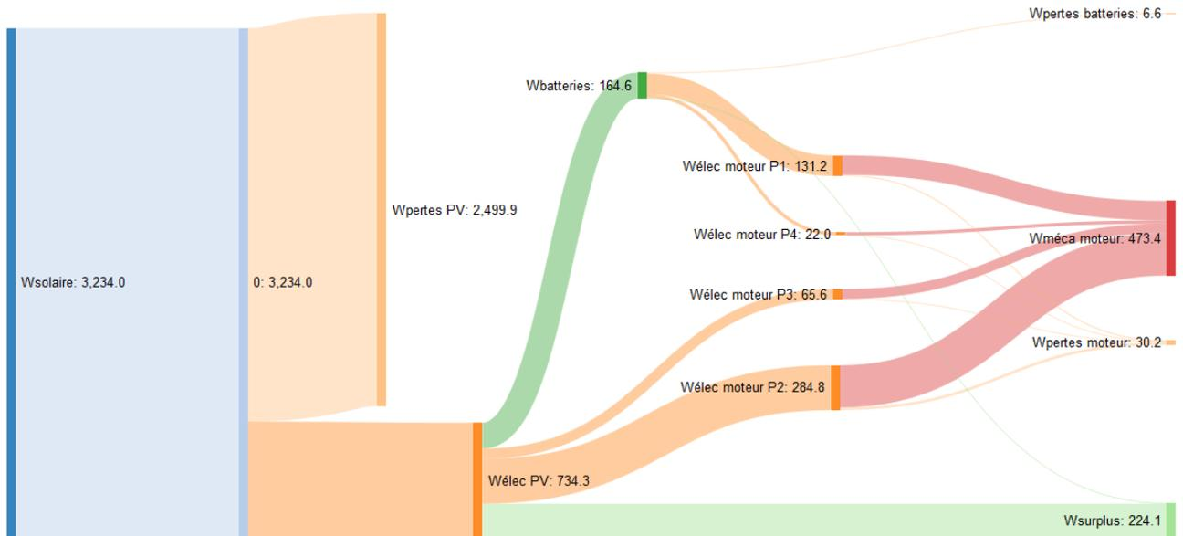
Question 4.12 | **Déterminer** le rendement global de la chaîne d'énergie du Solar Impulse 2 : entre l'énergie en entrée des panneaux photovoltaïques et l'énergie mécanique des moteurs (ne pas considérer les surplus dans le calcul du rendement).
