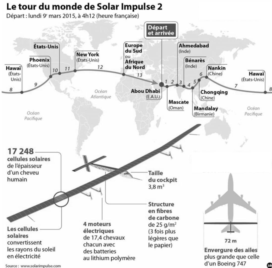
Le SOLAR IMPULSE 2 est basé sur des technologies récentes, comme les cellules photovoltaïques, les batteries au lithium-polymère et les matériaux ultralégers en fibre de carbone. Pour que le projet aboutisse, chaque élément de l'avion a été conçu et optimisé pour réduire la masse de l'avion, augmenter son aérodynamisme, réduire sa consommation d'énergie et maximiser le rendement des cellules photovoltaïques.
