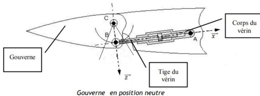
Question C.1 | **Représenter** sur le document réponse le vérin en position extrême rentrée et position extrême sortie. En **déduire** la course du vérin nécessaire pour réaliser ce débattement angulaire de  $60^\circ$  de la gouverne. **Conclure** quant à la performance de course du vérin par rapport au débattement angulaire de gouverne nécessaire.
